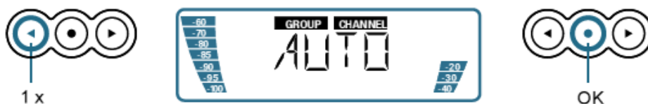
Mynd 53. Hér sést teikning af framhlið þráðlausa hljóðnemamóttakarans sem notaður er í dæminu hér á undan. Samstæðan er með læsiaðgerð en það er þó mikilvægt að hafa einhvern tiltækan sem þekkir búnaðinn vel, ef þörf krefur.
