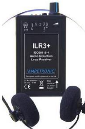
Mynd 30. Sambærilegt mælitæki frá Ampetronic. Hér er tækið sýnt með heyrnartólum til að kanna hljómgæðin. Taflan hér að ofan sýnir hvernig ljósið á að vera þegar virkni tónmöskvans hefur verið staðfest. Hér verður sem fyrr að halda tækinu lóðréttu og í sömu hæð og gefið er upp fyrir Univox Listener.
