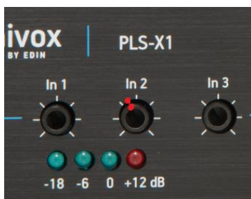
Mynd 54. Í dæminu þar sem þráðlausi hljóðneminn var tengdur við inntak 2: Gert er merki með tússpenna á brúnina á næmistillingunni og einnig á brúnina á framhliðinni. Rauðu merkingarnar má sjá á myndinni. Þannig er auðveldara að sjá hvort einhver óviðkomandi hefur breytt stillingunum, og færa þær aftur í samt lag. Hægt er að fara eins að við aðrar stillingar og tryggja sig þannig gegn óumbeðnum breytingum á stillingum.
