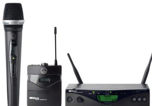
Mynd 42. AKG WMS 470 er samstæða með lausum hljóðnema með þétti (condenser) og hentar prýðilega fyrir tónmöskvakerfi. Þetta er talsvert þróaður búnaður með tíðnistillingu sem er að hluta sjálfvirk. Nota þarf móttakara (eins og þann til hægri) fyrir hvern hljóðnema. Fyrir vasasendinn er ráðlagt að nota höfuðtöl með spöng.
