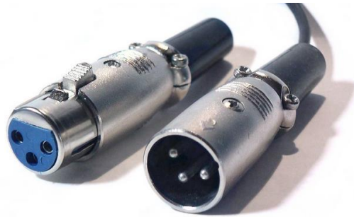
Mynd 38. Hér má sjá mynd af XLR-tengi (karl- og kventengi) sem má nota fyrir bæði hljóðnema og línumerki. Aftan á hljóðnemanum er kló sem samsvarar þeirri til hægri á myndinni. Heimild: Wikipedia
