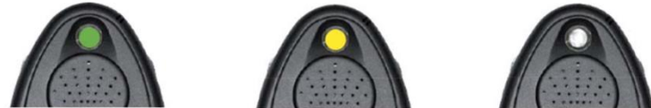
Mynd 28. Grænt ljós táknar að tónmöskvinn sé stilltur í samræmi við IEC-viðmiðið. Gult ljós táknar að tónmöskvinn virki en sé ekki stilltur í samræmi við IEC-viðmiðið. Ef ekkert ljós kviknar virkar tónmöskvinn alls ekki. Munið að nota heyrnartólin til að kanna hljómgæðin.
