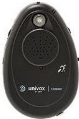
Mynd 29. Univox Listener er einfalt prófunarmælitæki með tengli fyrir heyrnartól og ljósi sem kviknar til að sýna að tónmöskvinn starfi rétt.
