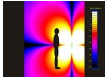
Mynd 61. Gula svæðið táknar svæðið þar sem styrkur tónmöskvans er réttur, miðað við borðmöskva, en það rauða táknar svæði þar sem eitthvert hljóð er greinanlegt. Heimild: Ampetronic
