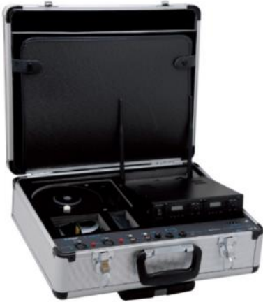
Mynd 59. Hér sést tónmöskvataska frá Univox. Í töskunni er tónmöskvamagnari með tengi- og stjórnþækjaborði í töskunni, spóla með tónmöskvaleiðslu sem hægt er að vinda ofan af og festa við gólfíð með límbandi og þráðlaus hljóðnemi með móttakara fyrir slíka hljóðnema.
