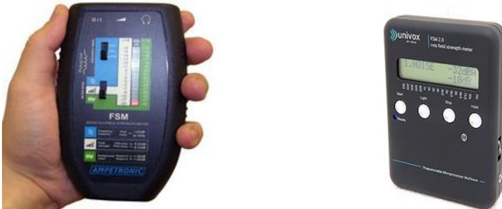
Mynd 27. Hér sjást tveir drægismælar sem notaðir eru við vottun tónmöskva. Til vinstri er Ampetronic FSM og til hægri Univox FSM 2. Mikilvægt er að halda tækjunum lóðréttum og í réttri hæð þegar mælt er.
