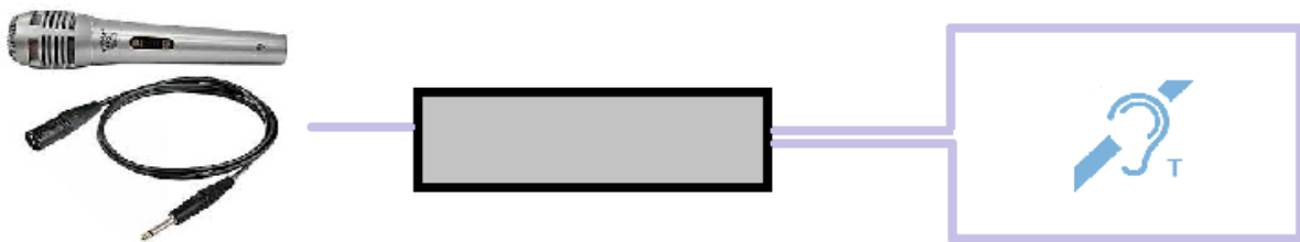
Mynd 10. Sambærileg lausn fyrir tónmöskva: hljóðnemi og leiðsla sem tengd eru við tónmöskvamagnara og tónmöskva(leiðslu) sem leidd er um rýmið.
