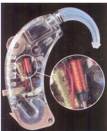
Mynd 6. Heyrnartæki með T-spólu. Tækið á myndinni er með gegnsærrri hlíf og því sést tónspólan, sem nemur hljóðið þegar tækið er í T-stillingu, greinilega.
