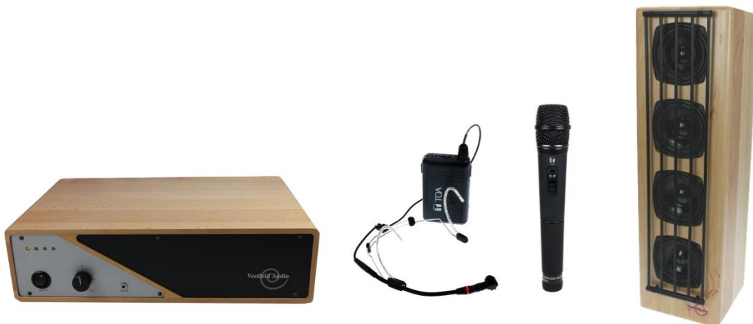
Mynd 56. Hér má sjá helstu hluta Audiolink-kerfisins – frá vinstri: grunnstöð, þráðlaus hljóðnemi með heyrnartólum með höfuðspöng, þráðlaus hljóðnemi fyrir hönd og hátalari. Í grunnstöðinni eru þráðlausir móttakarar og hún virkar sem magnari fyrir hátalarana, hljóðblander merki frá ýmsum inntökum og tryggir jafnan styrk merkisins til tónmöskvamagnarans.
